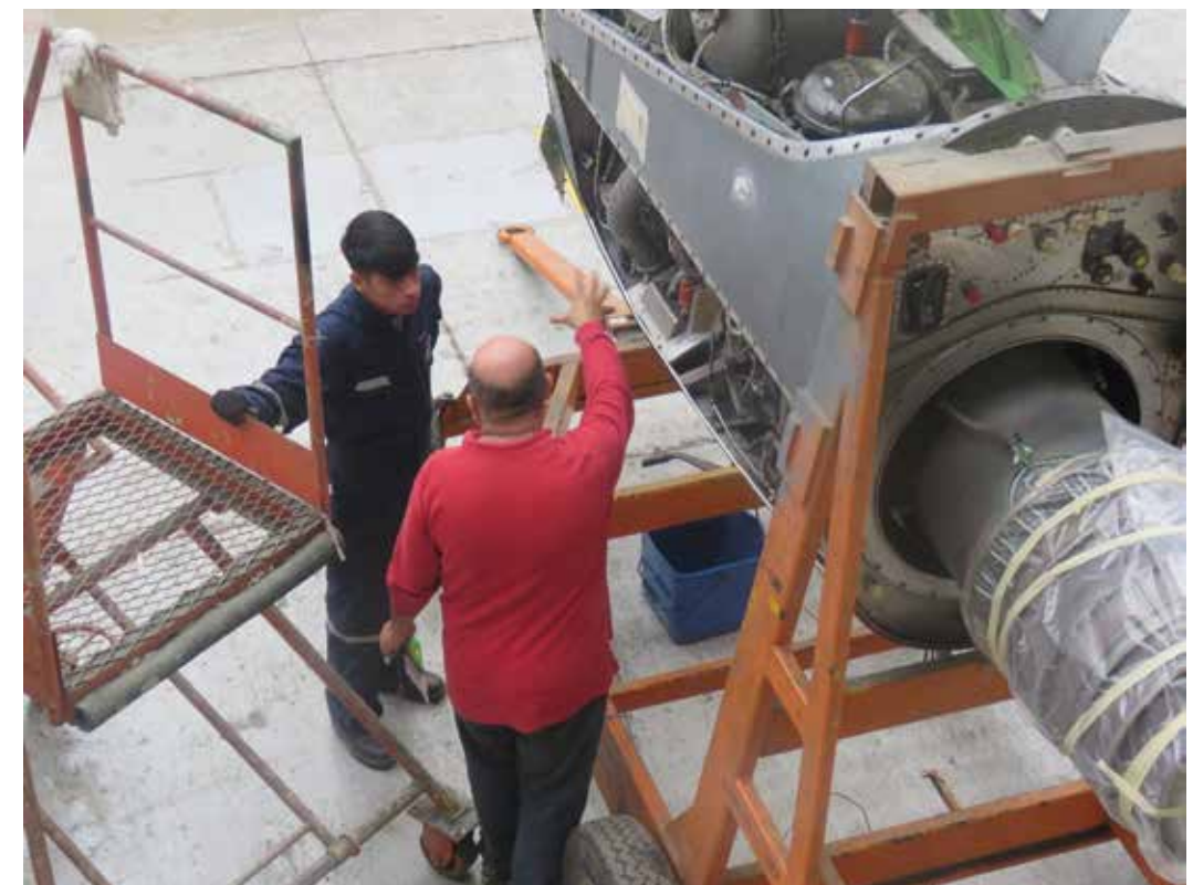
Alumno en instrucción de mantención de un motor T-56 de un avión C-130 de la FACH.
