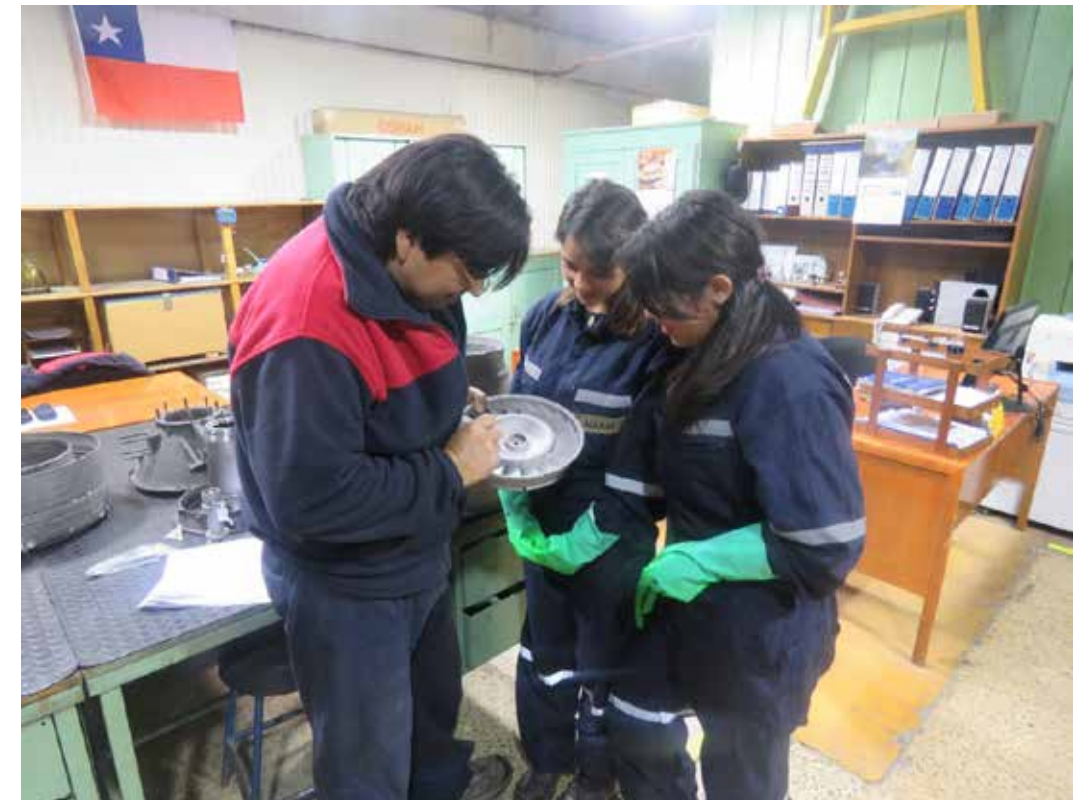
Supervisor explicando las condiciones de un accesorio de motor previo al proceso de inspección no destructiva por líquidos penetrantes.
