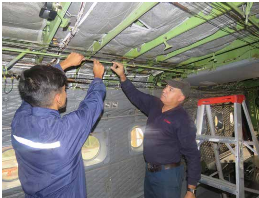
Alumno en practica recibiendo instrucción de conocimientos de los sistemas de mando al interior de un avión CASA 212 de la FACH.
