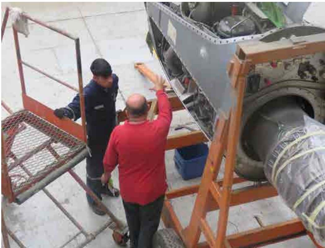
Alumno en instrucción de mantención de un motor T-56 de un avión C-130 de la FACH.
