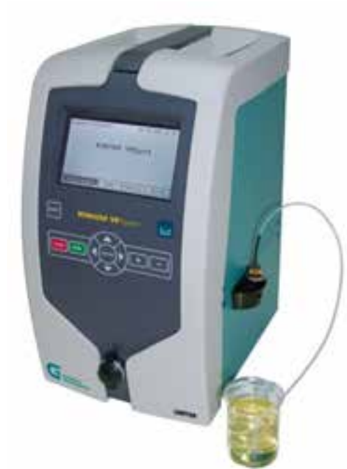
MEDIDOR DE PRESIÓN DE VAPOR
